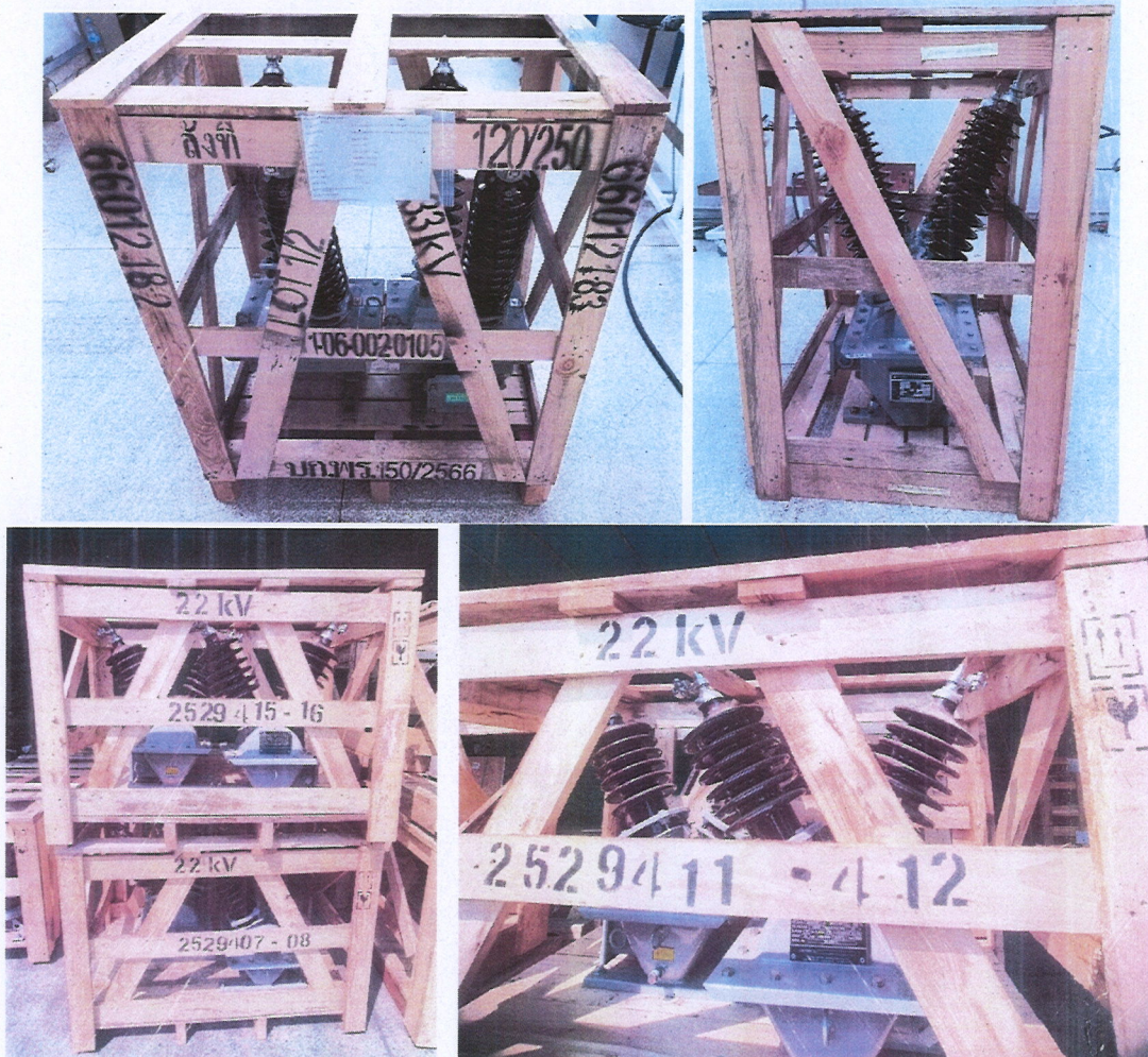
รูปที่ 4 ตัวอย่างบรรจุภัณฑ์ชั้นนอกสุดที่เป็นลังไม้
