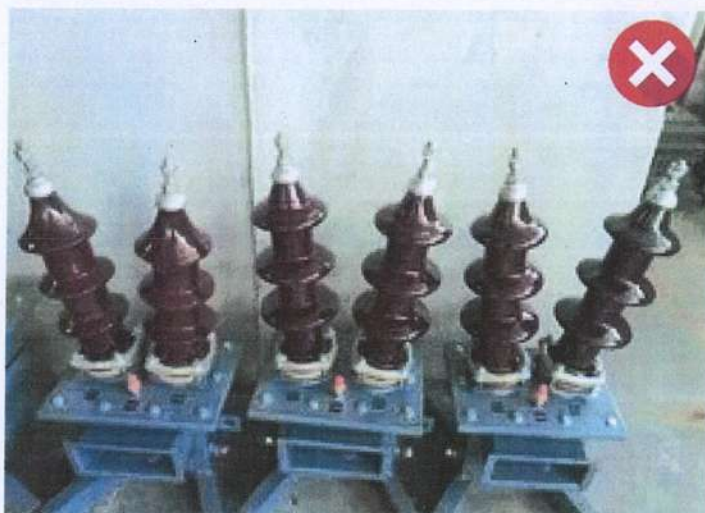
รูปที่ 9 ตัวอย่าง H.V. CT ประเภท 2 บุษซึ่ง (Double-bushing insulated)
