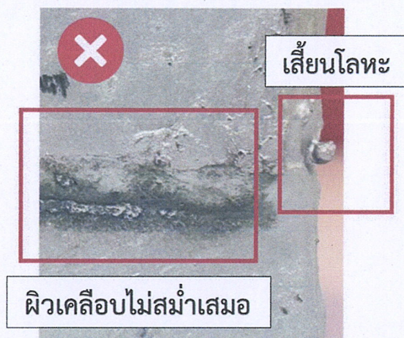
รูปที่ 7 ตัวอย่างผิวเคลือบไม่สม่ำเสมอ และมีเสี้ยนโลหะ
