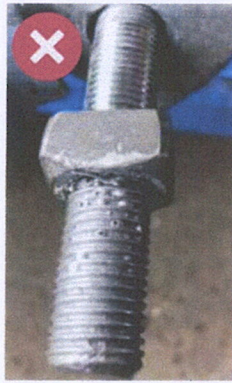
รูปที่ 10 ตัวอย่างอุปกรณ์สลักเกลียวมีผิวเคลือบไม่สม่ำเสมอ ไม่เรียบร้อย
