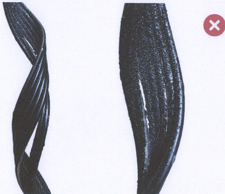
รูปที่ 10 ตัวอย่างเส้นลวดอลูมิเนียม (Rods) ของปรีฟอร์มเข้าปลายสาย แตกออกจากกัน
