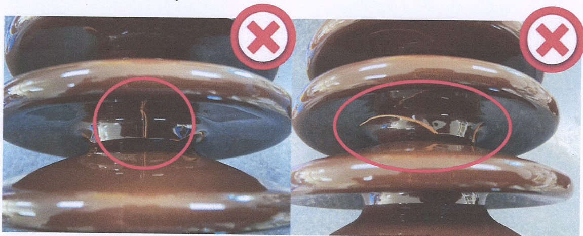
รูปที่ 8 ตัวอย่างรอยแตกบนผิวลูกถ้วย
