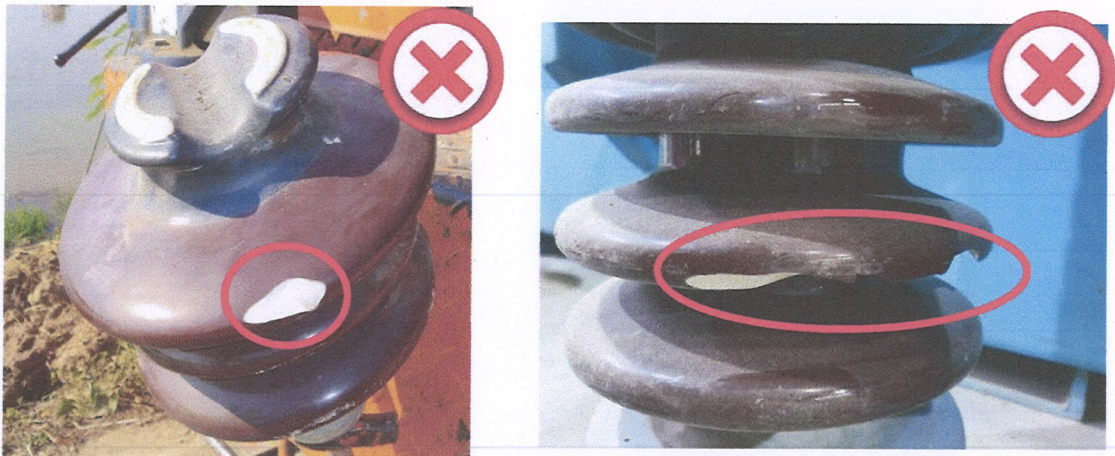
รูปที่ 9 ตัวอย่างรอยตำหนิบนปีกลูกถ้วย
