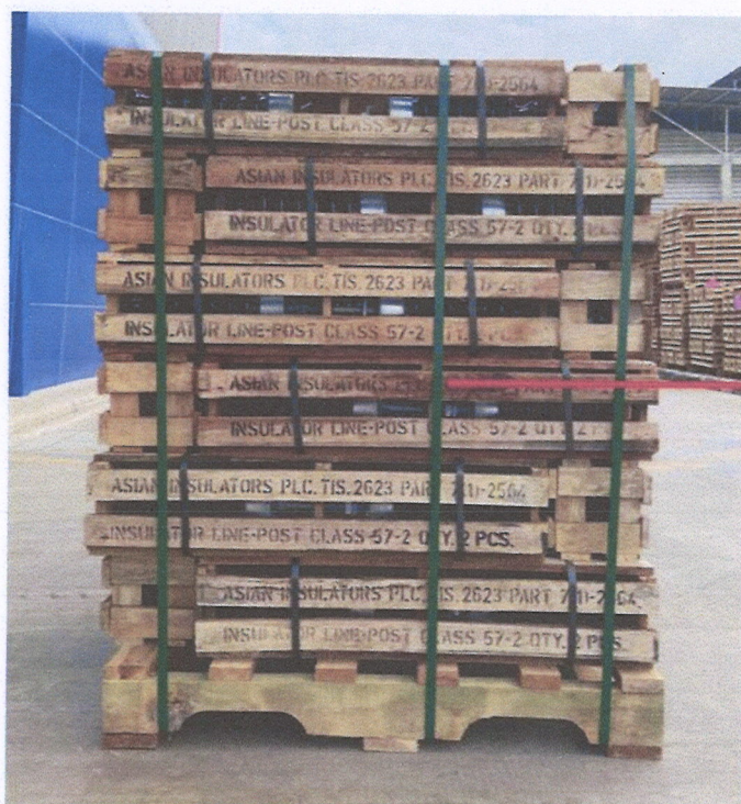
รูปที่ 4 ตัวอย่างการบรรจุแบบมัดรวมบนพาเลท
