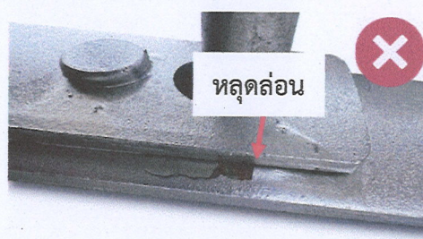
รูปที่ 9 ตัวอย่างผิวเคลือบสีของอุปกรณ์แรงต่ำสำหรับติดตั้งลูกรอกแนวนอน ไม่สม่ำเสมอ ไม่เรียบร้อย หลุดล่อน
