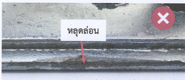
รูปที่ 9 ตัวอย่างผิวเคลือบสีของอุปกรณ์แรงต่ำสำหรับติดตั้งลูกรอกแนวนอน ไม่สม่ำเสมอ ไม่เรียบร้อย หลุดล่อน
