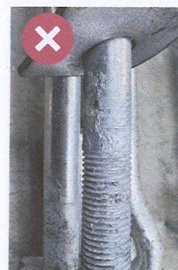
รูปที่ 10 ตัวอย่างอุปกรณ์สลักเกลียวมีผิวเคลือบไม่สม่ำเสมอ ไม่เรียบร้อย
