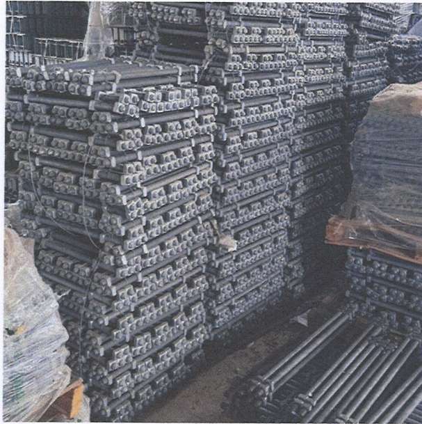
รูปที่ 7 ตัวอย่างการรัดอุปกรณ์สลักเกลียว ด้วยลวดเหล็กอบสังกะสี (Galvanized steel wire)
