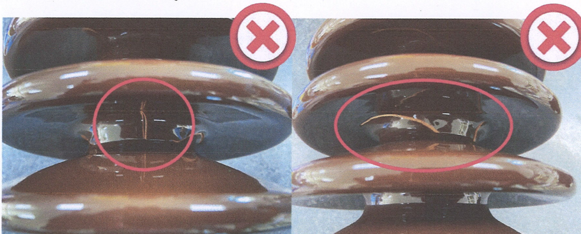
รูปที่ 7 ตัวอย่างรอยแตกบนผิวลูกถ้วย
