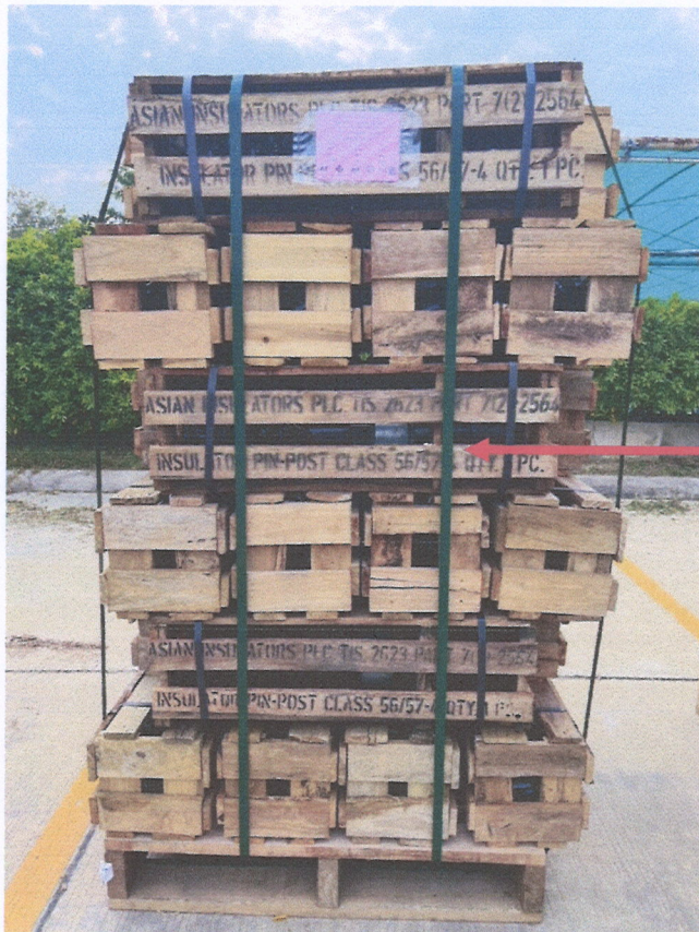
รูปที่ 4 ตัวอย่างการบรรจุแบบมีดรวมบนพาเลท
