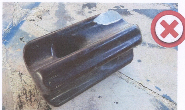
รูปที่ 7 ตัวอย่างรอยแตกบนผิวลูกถ้วย
