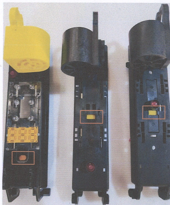
รูปที่ 20 แสดงตัวอย่าง กรณีไม่ติดตั้ง HRC fuse link จะมีแถบสีเหลืองปรากฏ
