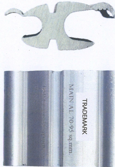
รูปที่ 7 ตัวอย่างการตรวจสอบรูปร่างและลักษณะของคอนเนคเตอร์ชนิดบีบแบบเอชเปรียบเทียบกับแบบ (Drawing)
