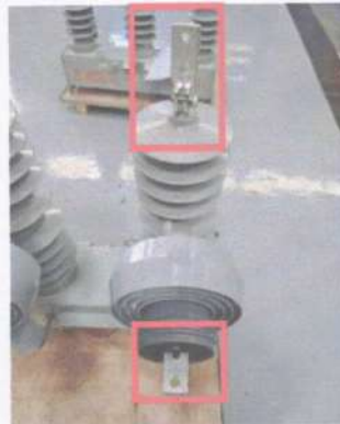
รูปที่ 8 Terminal bushings พร้อม Terminal pad แบบ 2 รู
