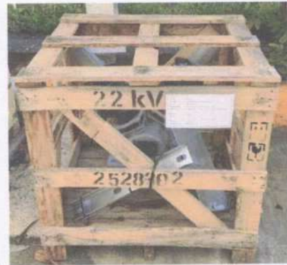
รูปที่ 3 ตัวอย่างบรรจุภัณฑ์ของหม้อแปลงแรงดัน (Voltage transformer)
