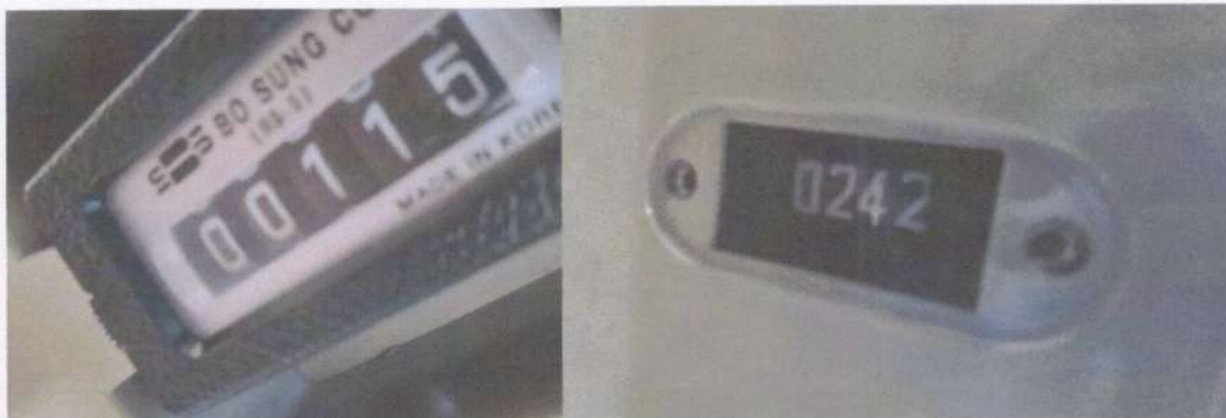
รูปที่ 16 ตัวอย่างตัวนับจำนวนการทำงานของวงจรหลัก
