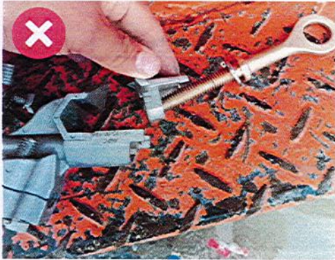
รูปที่ 10 ส่วน Eyescrew และ Keeper หลุดออกขณะขันคลายออกจนสุดระยะเกลียว
