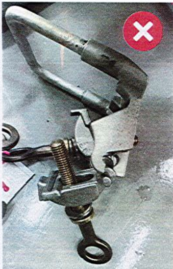
รูปที่ 12 ส่วน Eyebolts หลุดออกขณะขันคลายออกจนสุดระยะเกลียว
