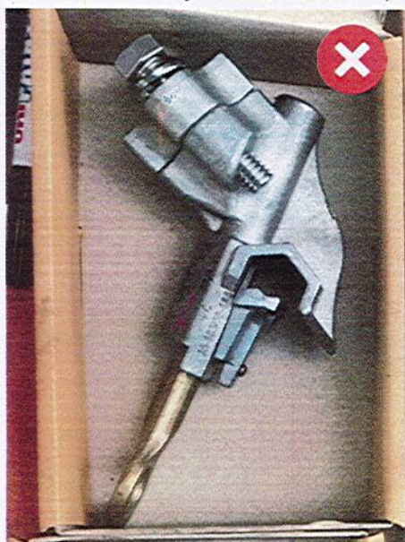
รูปที่ 7 ตัวอย่างบรรจุภัณฑ์เฉพาะหน่วยของฮอทไลน์แคลมป์แบบไม่ปิดผนึก ไม่สามารถป้องกันความชื้นหรือฝุ่นละออง เข้าไปสัมผัสกับคอมปาวด์ (Oxide Inhibiting Compound)
