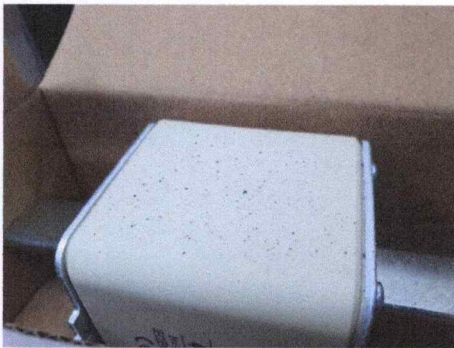
รูปที่ 9 อุปกรณ์ไม่สมบูรณ์เนื่องจากพบทรายภายใน อุปกรณ์หลุดออกมาภายนอก
