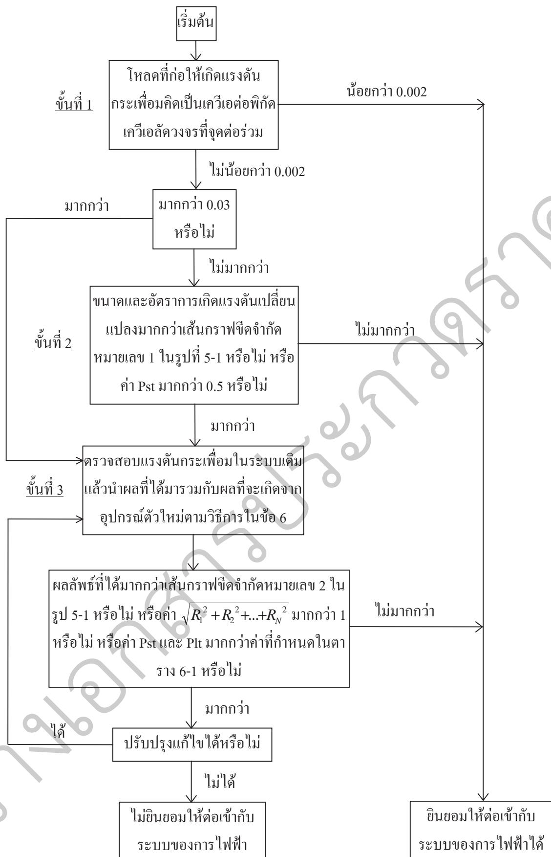
รูปที่ พ-1 แผนผังลำดับขั้นตอนการตรวจสอบทดสอบที่ก่อให้เกิดแรงดันกระเพื่อม
