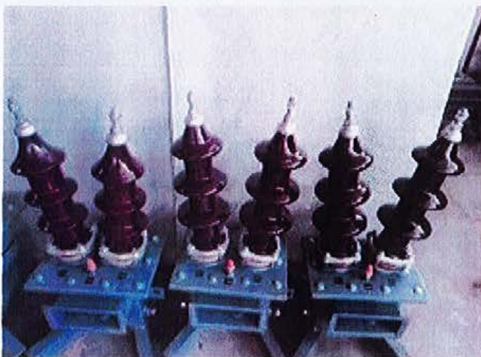
รูปที่ 9 ตัวอย่าง H.V. CT ประเภท 2 บุชชิ่ง (Double-bushing insulated)
