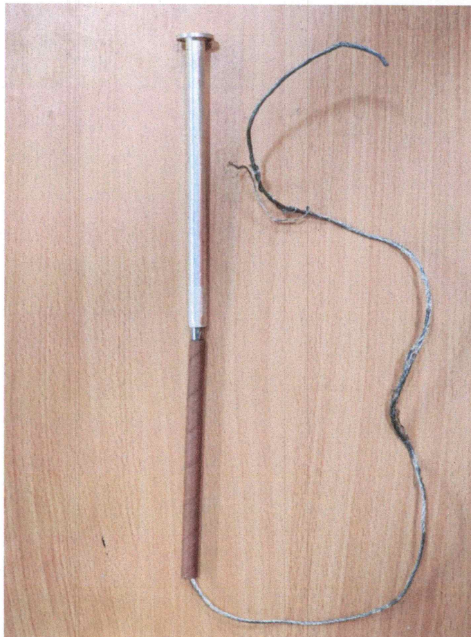
รูปที่ 6 การประกอบ Arc shortening rod เข้ากับฟิวส์ลิงค์
